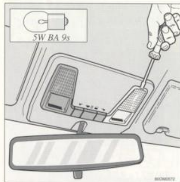
Schroevendraaier insteken, voorzichtig draaien en naar beneden trekken
