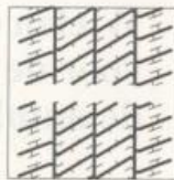
Slijtageprofiel zichtbaar, normale slijtage
