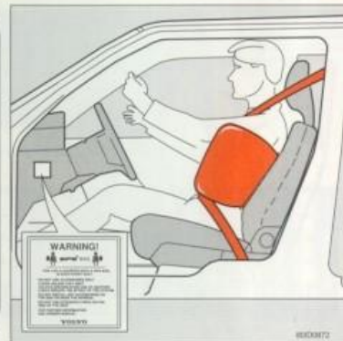
Opblazen van de zijdelingse airbag
